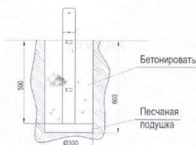
Схема установки закладной для спортивных комплексов СП
